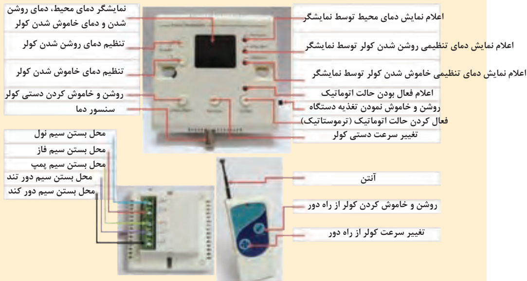
مدار کلید هوشمند کولر آبی
