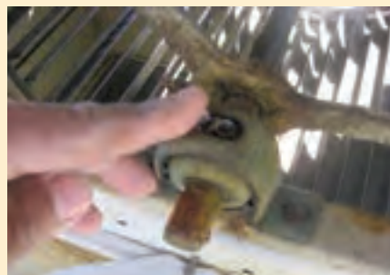
محل روغن کاری یاتاقان
