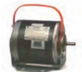
موتور بدون خازن راه‌انداز
